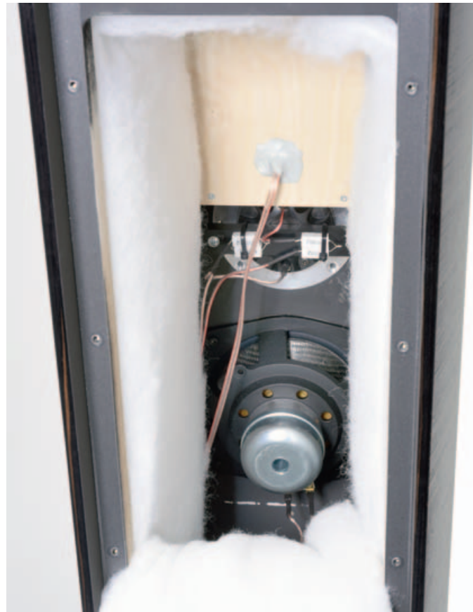
Unten erkennt man die – sensorgeregelten – Carbon-Bässe, in der Mitte den per Widerstandsnetzwerk pegelreduzierten Hochtöner. Die Mitteltonkalotte spielt verschlossen in eigenem Volumen (oben).
