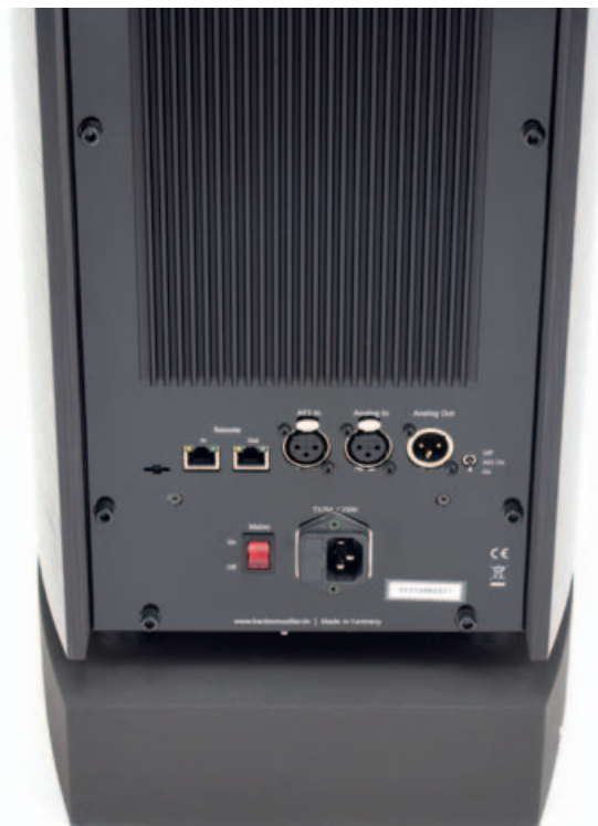
Die Weichen-/Wandler-/Verstärkereinheit der BMprime 12 sitzt im Fuß und akzeptiert digitale sowie analoge Signale per XLR. Die Ethernet-Buchsen dienen dem Zugriff per Software, etwa zur Einmessung.
