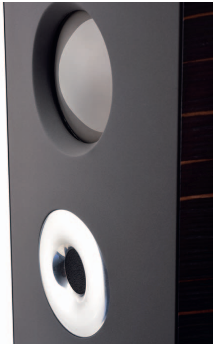
Die Mitteltonkalotte (oben) besteht aus beschichtetem Aluminium und ist ausschließlich für Mittelton zuständig. Alle Frequenzen oberhalb 900 Hz gibt der Ringradiator im Alu-Waveguide wieder.
