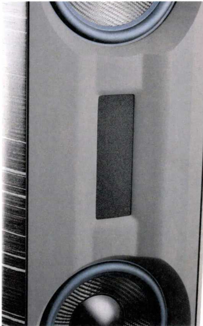
Fast der gesamte Mittelhochton ab etwa 1000 Hz wird bei der BMPrime von einem einzigen Chassis wiedergegeben, einem Air Motion Transformer. Der wirkt in der Vertikalen als Zeilenstrahler, in der Horizontalen hilft eine Schallführung für homogenes Abstrahlen.
